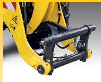
Elektrycznie aktywowane szybkołączące dla szybszej i łatwiejszej wymiany osprzętu
