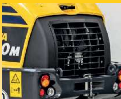
Chłodnica z szerokim rdzeniem i opcjonalnym dwukierunkowym wentylatorem
