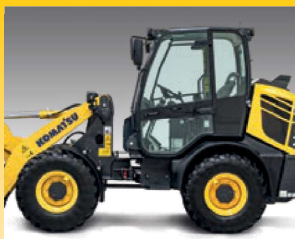
Mała wysokość całkowita (2,48 m), ułatwiająca transport maszyny
