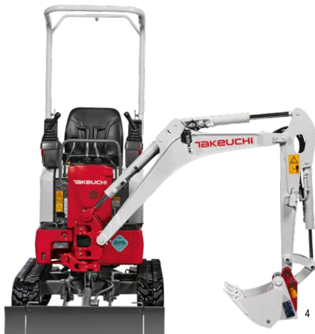
PRZESUNIĘCIE RAMIENIA W LEWO O 85°
