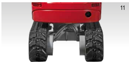
SZEROKOŚĆ PODWOZIA 750 MM
