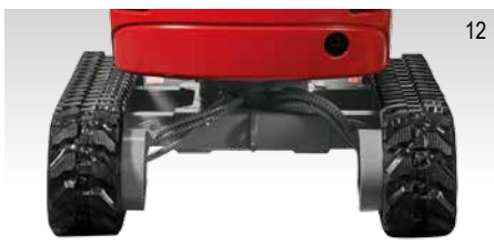
SZEROKOŚĆ PODWOZIA 1.020 MM
