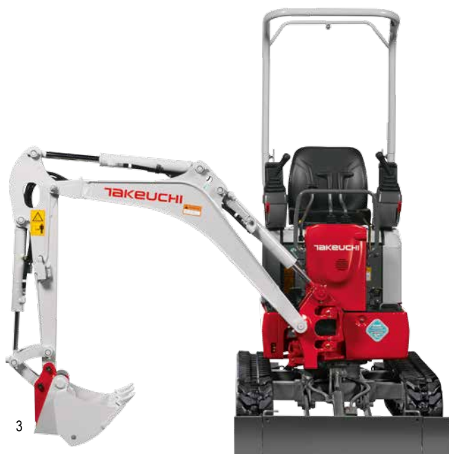
PRZESUNIĘCIE RAMIENIA W PRAWO O 85°
